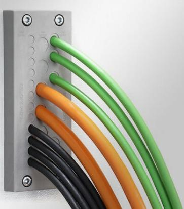
KEL-DPZ CR电缆引入底板用于在狭小的空间内排布和密封大量标准电缆，软管或光纤（直径从1.5到22mm）。
